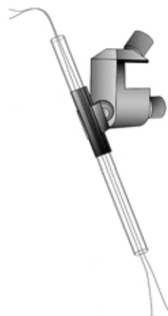
図6. 通常の銀線電極と電極支持具（ボール・ジョイント式）。
