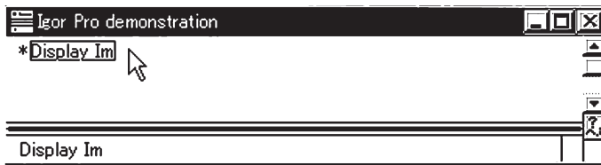
図3. History領域（上の広いスペース）とcommand領域（最下段の空白行）. この二つは一つのexperimentファイルに必ず1セット組になって表示され、windowのタイトル部にはexperimentファイル名が表示される. この二つを持たないexperimentファイルはない.
