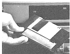
ハード・ディスク・オプション:44Mバイトの脱着式バルヌイ・ディスク搭載
